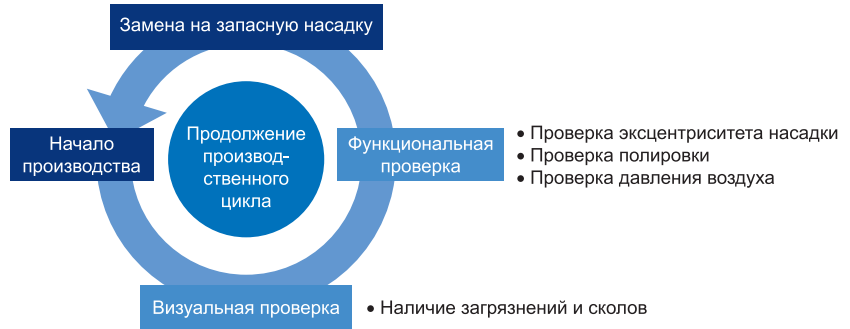
Рис. 6. Проверка состояния насадок
